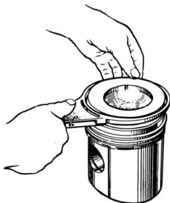
Рис. 80. Снятие и надевание поршневых колец на поршень
